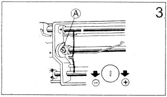
旋梭的油量,可以用油量调节螺钉A加以调节。按图示"+"号方向旋转,油量增加,"-"号方向旋转,油量减少。
