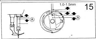
把针杆从最低位置上升到距离A时,旋梭的钩线尖D应与机针 C的中心线重合。此时,钩线尖D应高于机针线孔上边1.0-1.5毫米。 Time needle to rotating hook.
