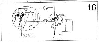
旋梭尖与机针的侧面间隙为0.05毫米。
