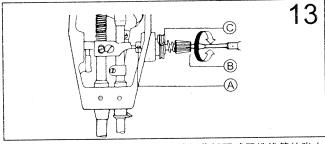
挑线簧摆动幅度为8-10毫米,缝纫薄料要减弱挑线簧的张力和放宽其摆动幅度,缝制特别厚的缝料则反之。
