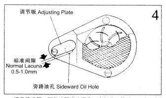
通常情况下,不作油泵进油调节,在低速运转时,观察油窗,没见油现象,请合拢间隙。
