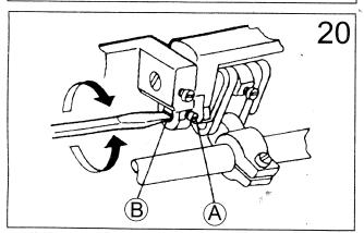
旋松螺钉A,旋转"连杆偏心轴"B,向右旋,顺缝针距变小,倒缝针距变大,向左旋,顺缝针距变大,倒缝针距变小。
