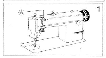
新机器在开始使用时,先卸下机头上部的橡皮塞A,充分加油,然后抬起压脚进行低速盖2000多转/分,观察油窗喷油情况,润滑正常后,仍须保持低速运转30分钟,以后逐步提高速度,充分磨合大约需一个月左右。
