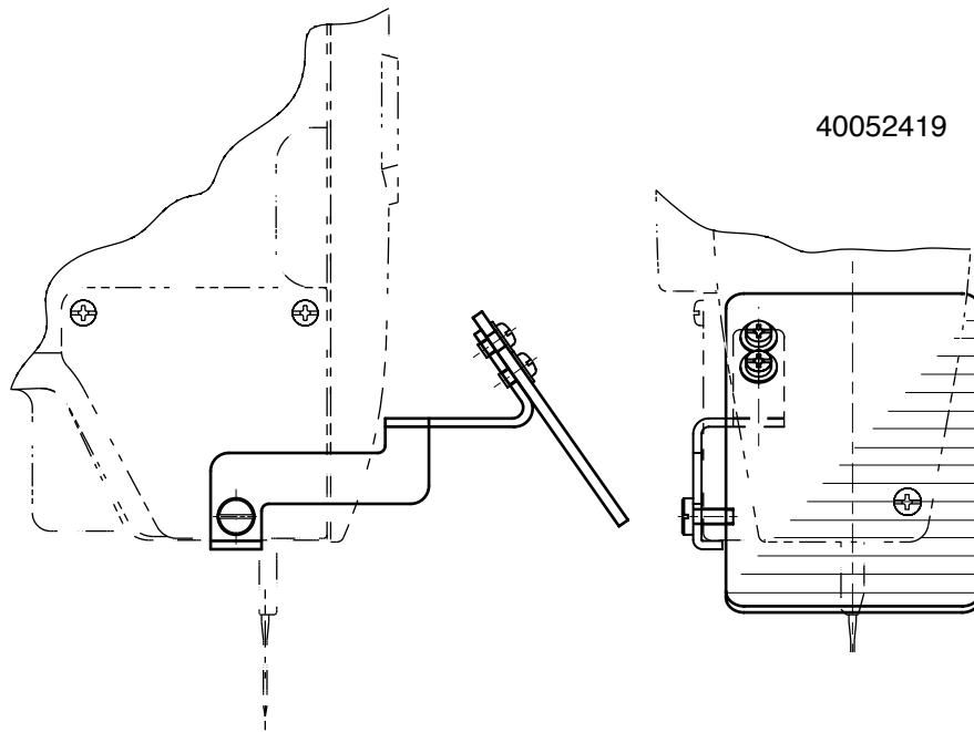
ミシンを使用する前に必ずミシン頭部のねじを用いて、安全プレート取付板を図のように取り付けること。
